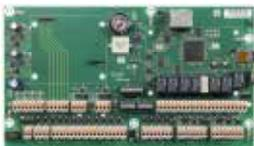
\*) An eine RS485-Schnittstelle können bis zu 2 RFID-Schreib-Leser angeschlossen werden (z. B. über das Türmodul iDJ-1). Zusätzlich können weitere Erweiterungsmodulare an die RS485-Schnittstelle angeschlossen werden. Es stehen bis zu 8 Adressen zur Verfügung.
